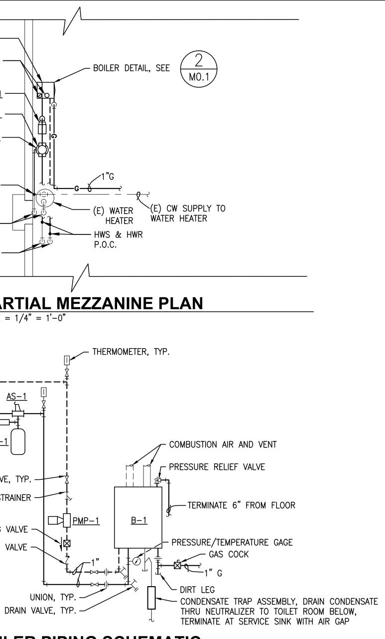
**BOILER PIPING SCHEMATIC**
